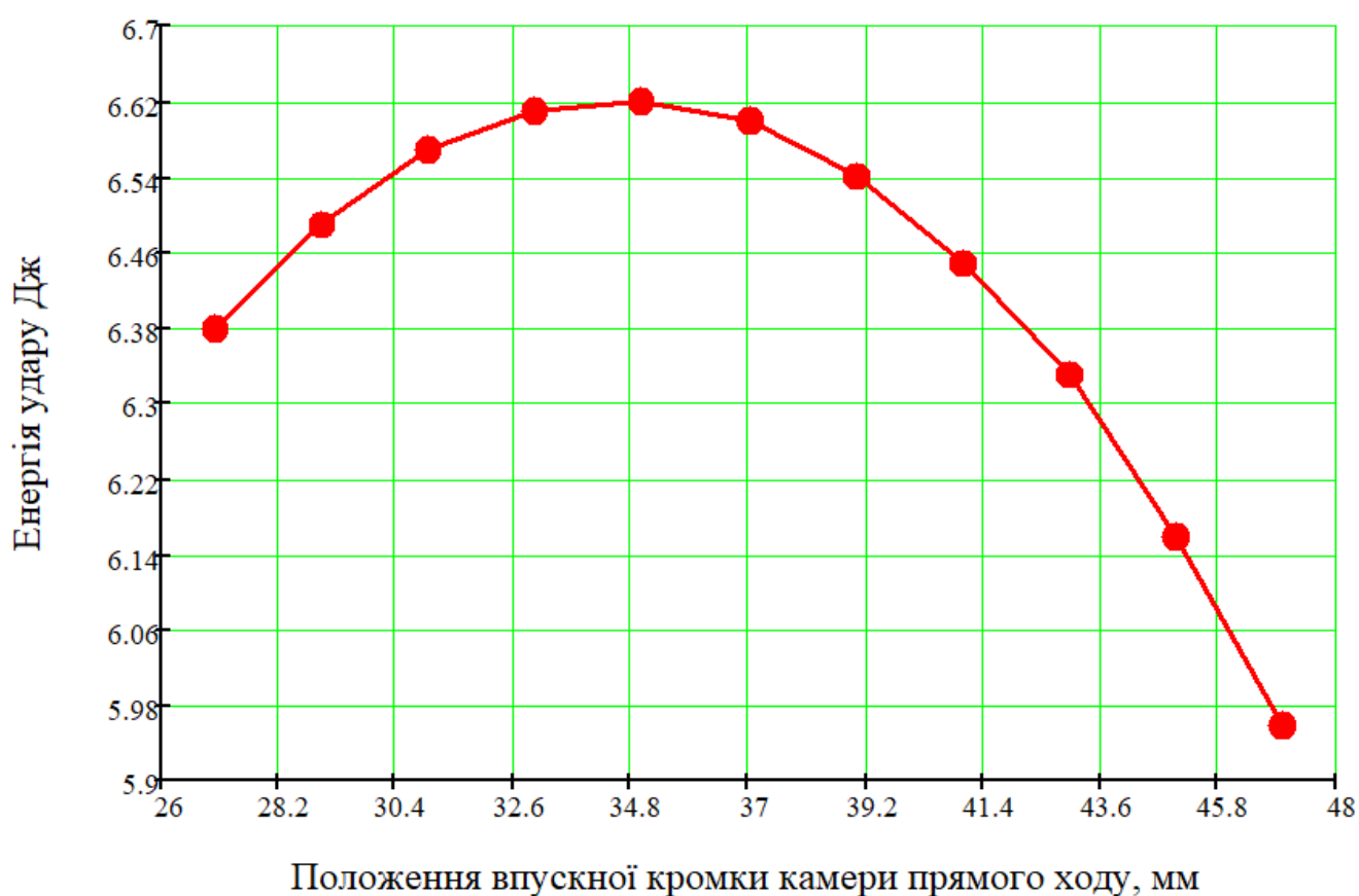
Рис 3.5 - Залежність енергії удару від положення впускної кромки камери прямого ходу
