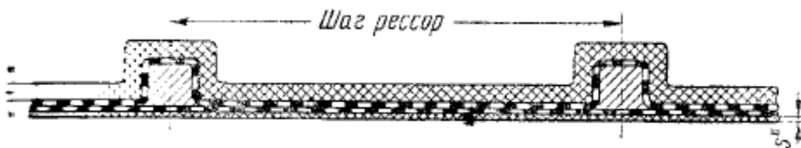
Рисунок 4.3 – Поперечний перетин полегшеної конструкції стрічки
