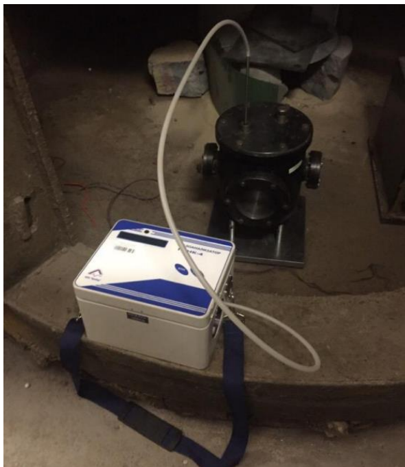
Рисунок 3.9. Схема вимірювання викидів оксиду азоту.
