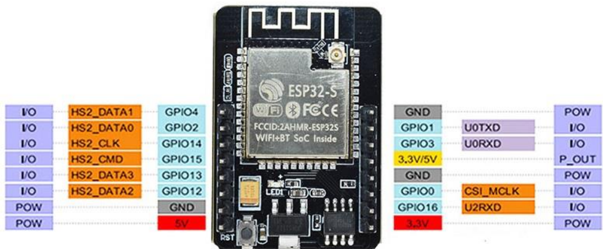
Рисунок 3.1 - Розташування та призначення контактів.
