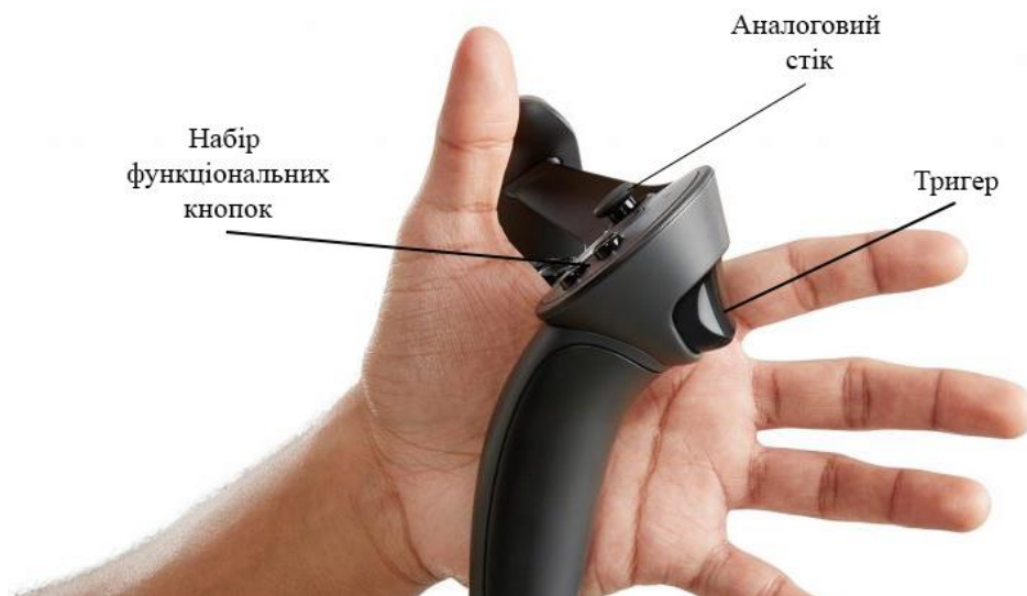
Рисунок 1.18 – Елементи управління на VR контролері
