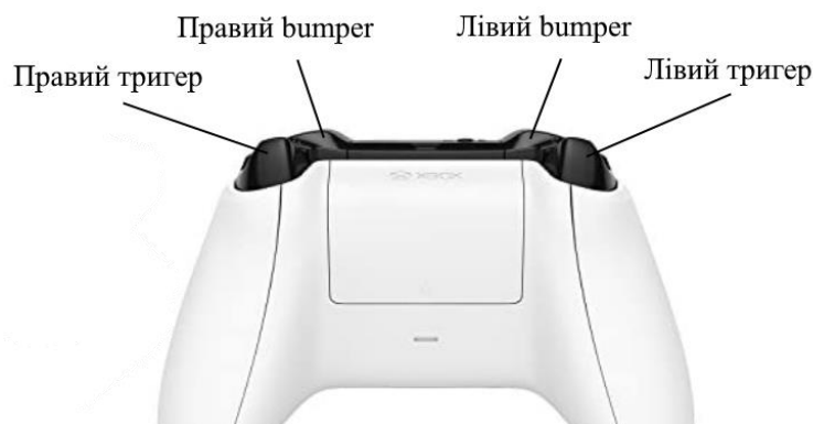
Рисунок 1.7 – Елементи управління на задній панелі геймпада
