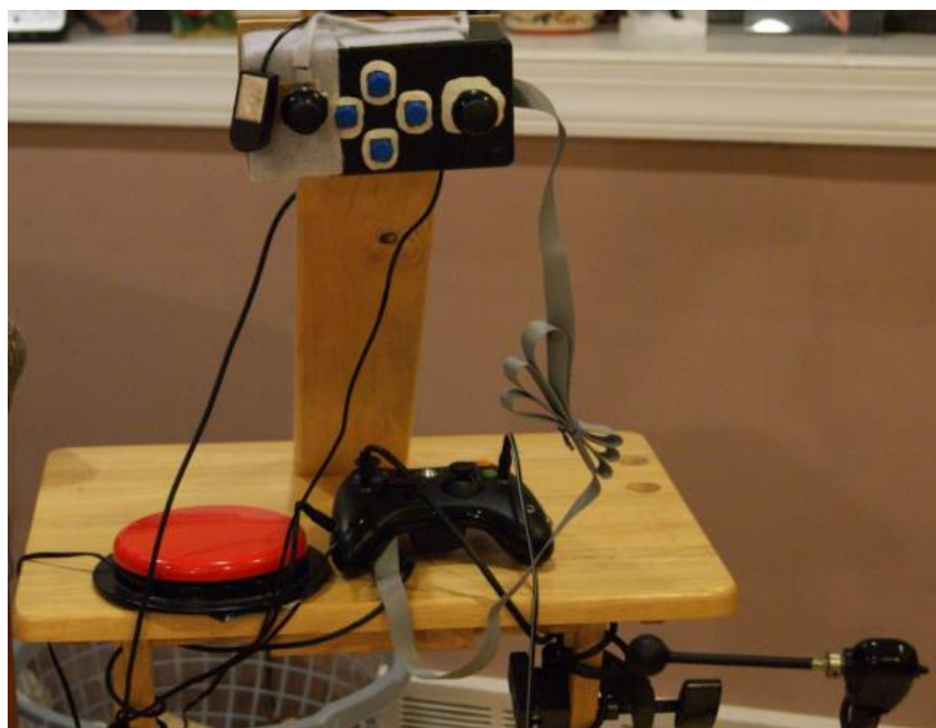
Рисунок 1.23 – Модифікований контролер Evil для людей з певними обмеженими можливостями
