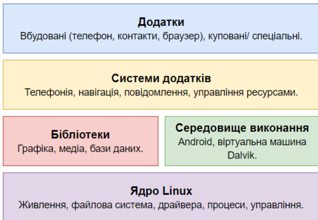
Рисунок 1.6 – Рівні програмного забезпечення Android
