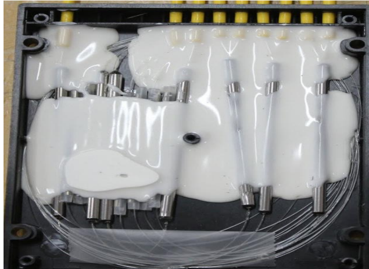
Рисунок 1.50 – Приклад коплера 1x8 всередині
