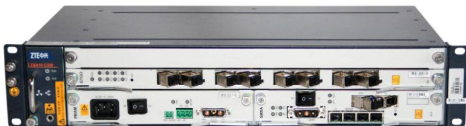
Рисунок 1.61 – Схема розположення слотів в шасі OLT ZTE ZXA10 C320 Інтерфейс.
