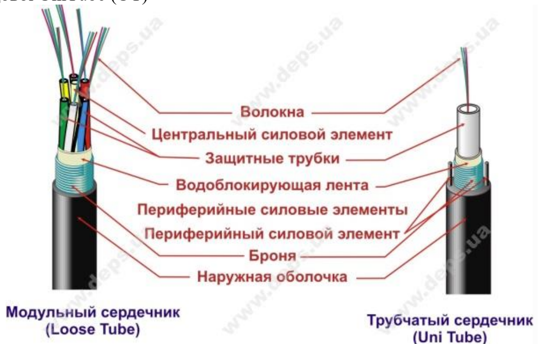
Рисунок 1.15 – Конструкція кабелів
