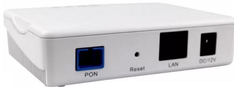
Рисунок 1.43 - Абонентський термінал ONU BDCOM P1501DT
