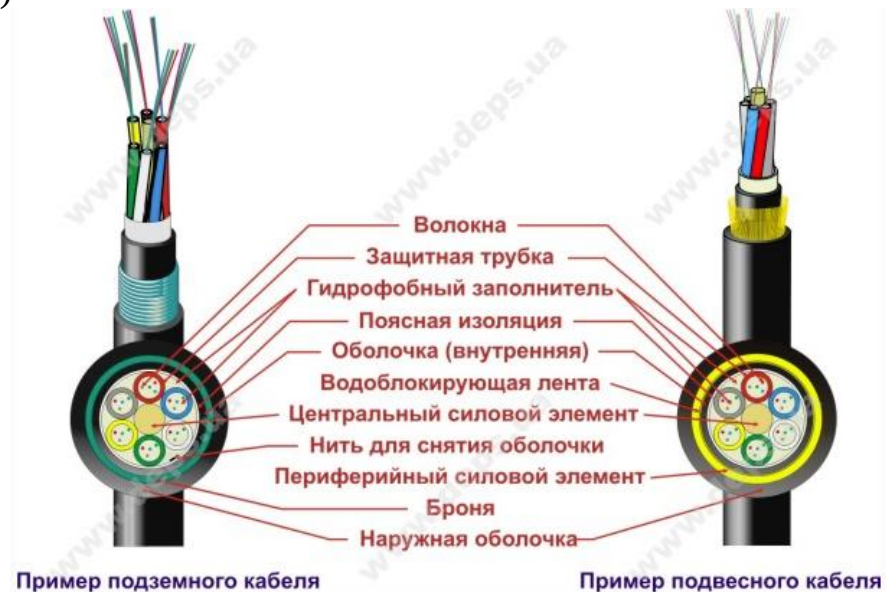
Рисунок 1.16 – Приклад підземного та підвісного кабелів
