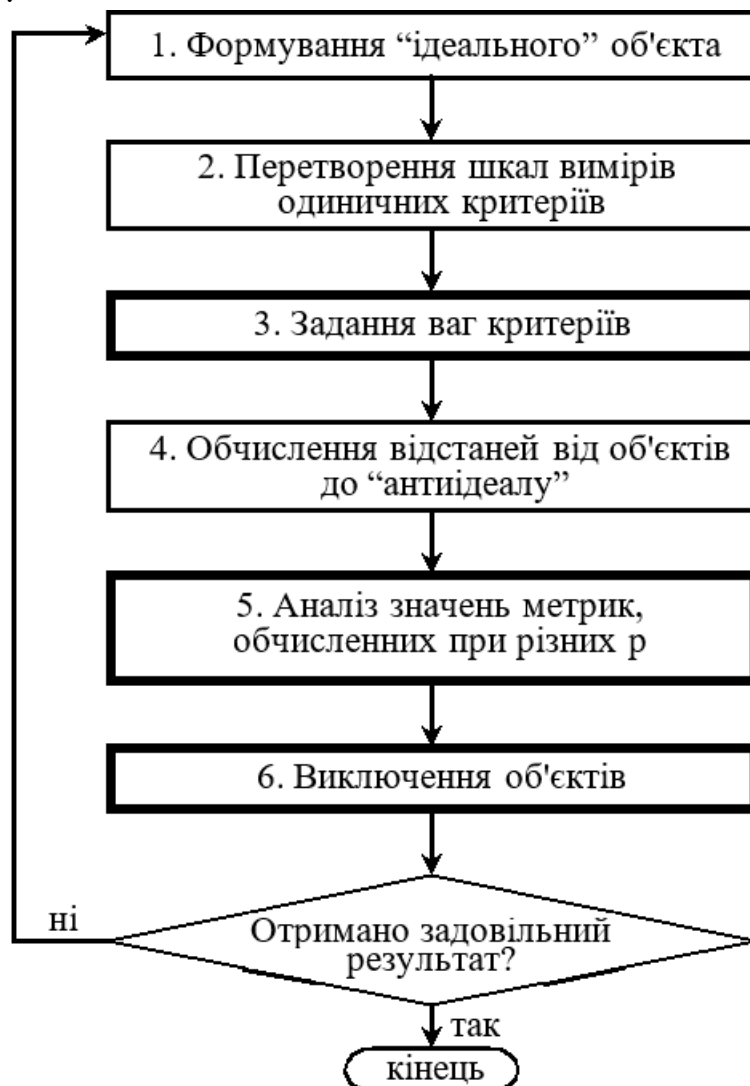
Рис .4.2 – Блок-схема методу суміщеного ідеалу
