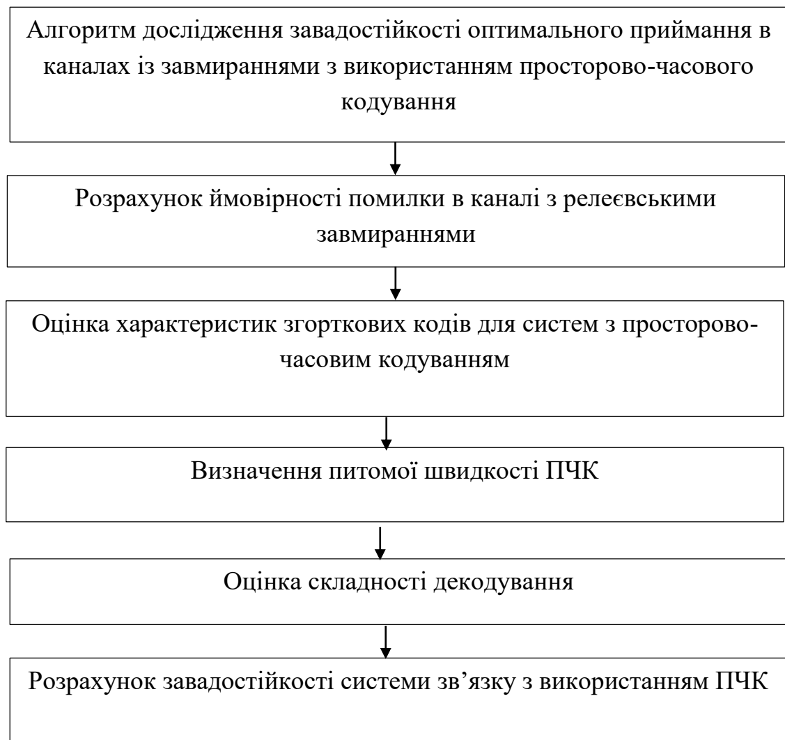
Рисунок 4.4 – Алгоритм дослідження завадостійкості оптимального приймання в каналах із замираннями з використанням просторово-часового кодування
