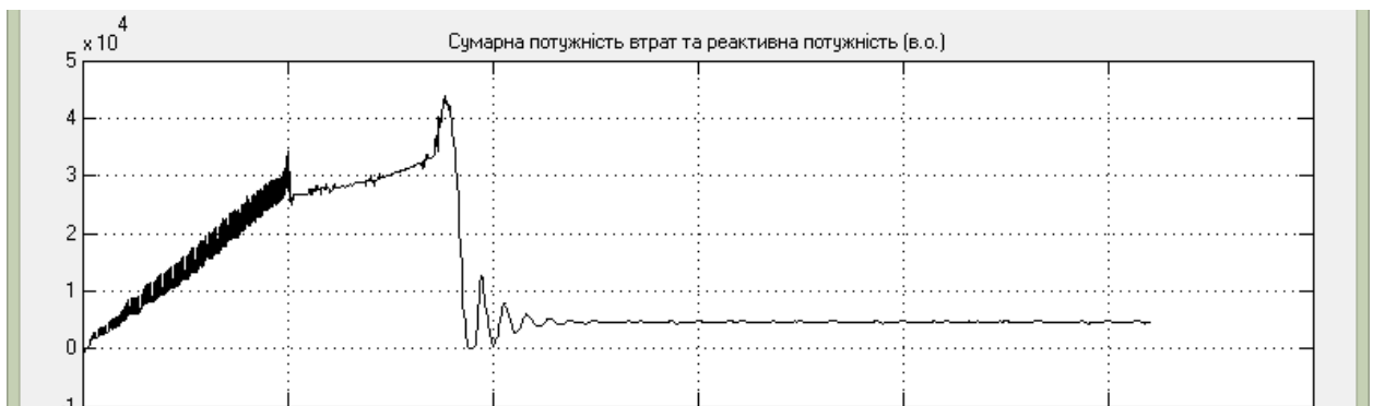
Рисунок 4.8 – Часові діаграми плавного запуску а) та енергоспоживання б) електроприводу пересування візка при U_{z0} = 0 В
