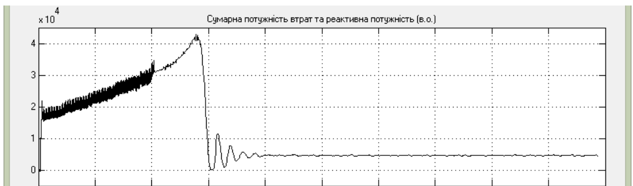
Рисунок 4.9 – Часові діаграми плавного запуску а) та енергоспоживання б) електроприводу пересування візка при U_{z0} = 6 В
