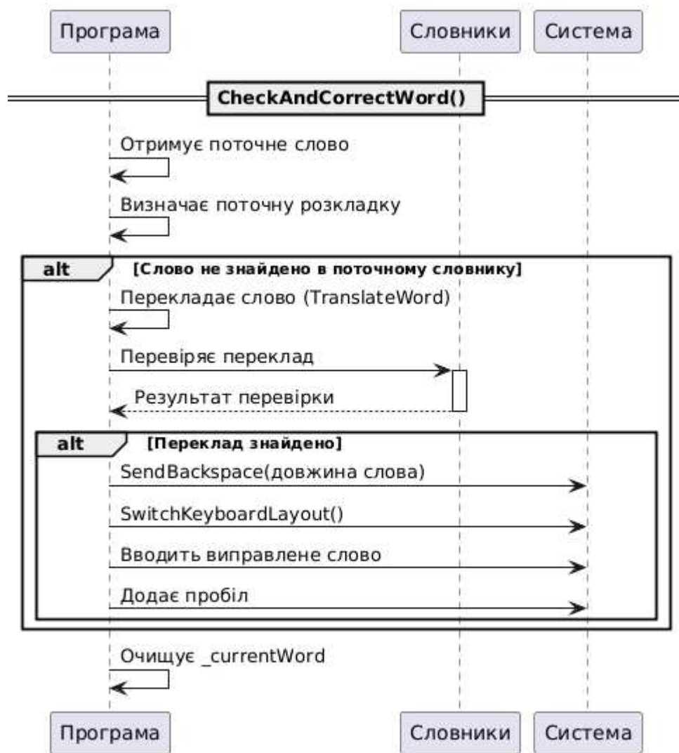
Рисунок 3.2 – Діаграма послідовності для перевірки та виправлення введеного слова
