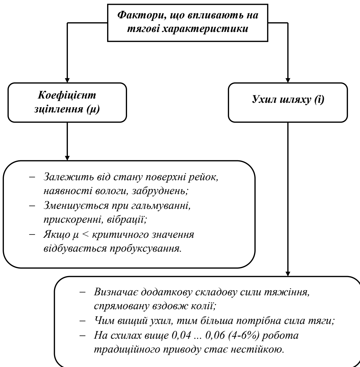
Рисунок 1.3.1 Вплив коефіцієнта зчіплення та ухилу шляху на тягові характеристики
