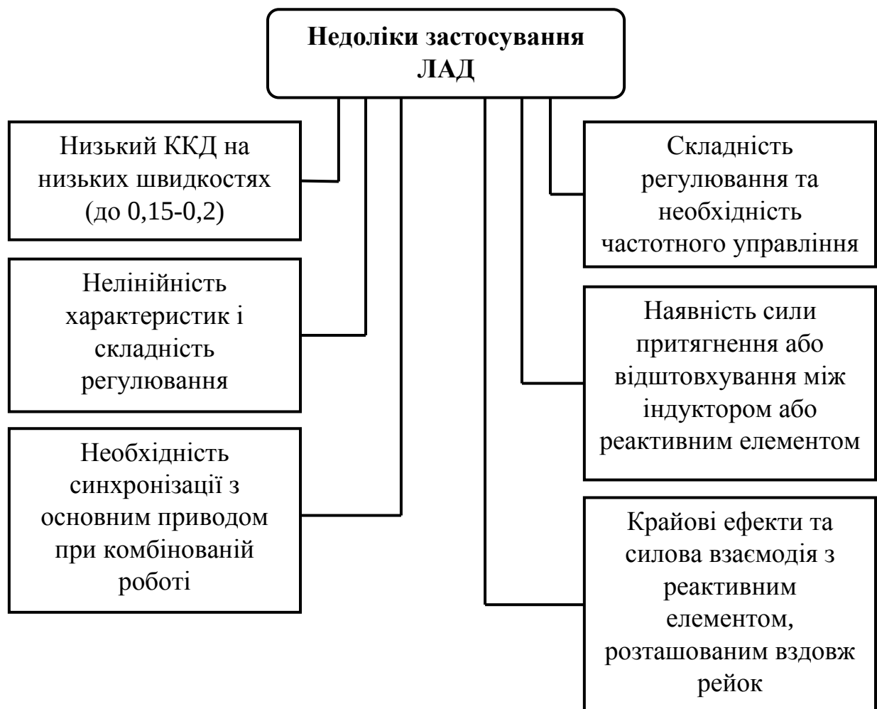
Рисунок 1.4.2. Недоліки застосування лінійного асинхронного двигуна
