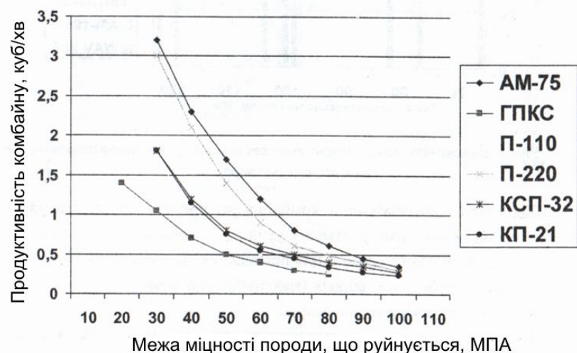
Рис. 1.6. Залежність продуктивності різних комбайнів (включаючи АМ-75) від міцності порід
