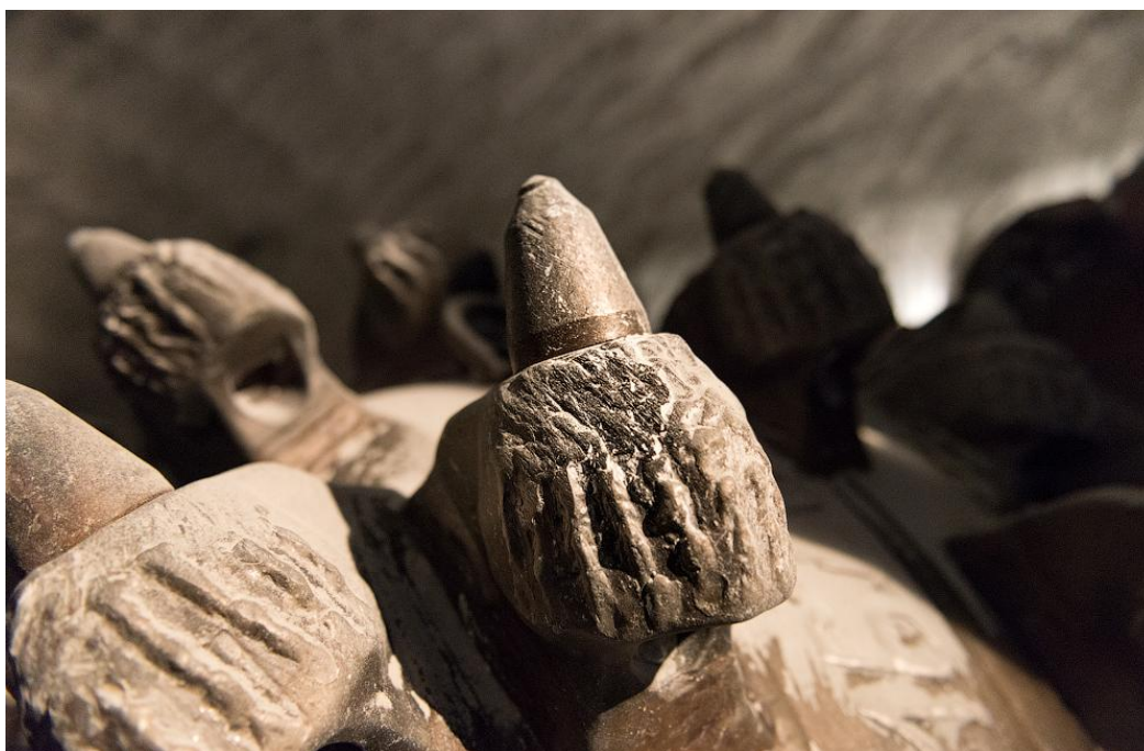
Рис.1.4. Зовнішній вигляд зубів коронки комбайна після тривалої роботи
