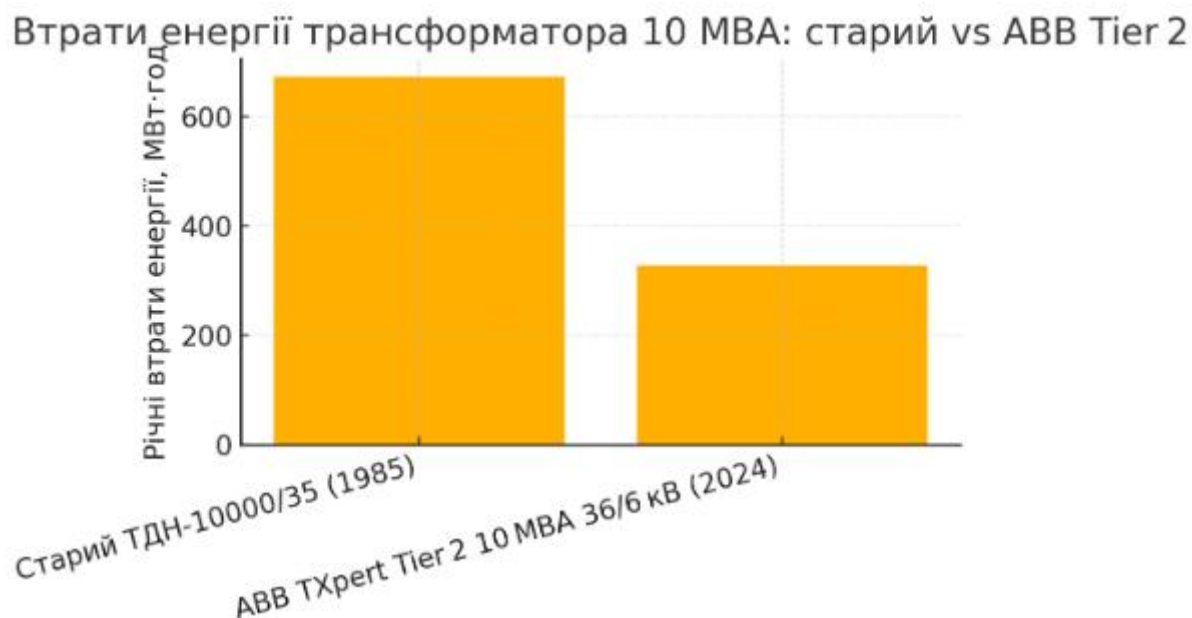
Рисунок 2.3 Графік порівняння втрат в силових трансформаторах
