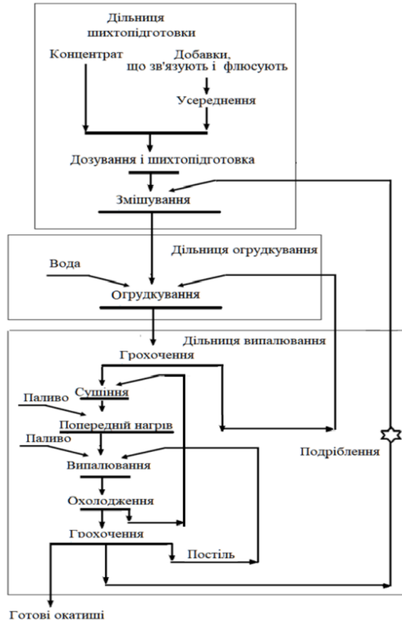
Рис. 1.1. Технологічна схема виробництва окатишів з термічним обробленням
