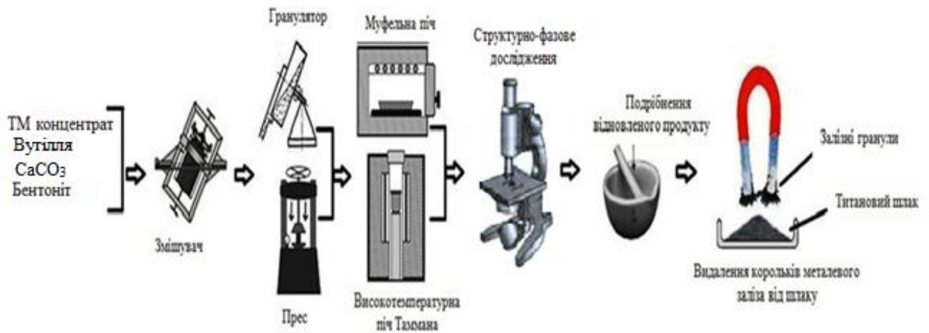
Рисунок 2.1 Методика відновлювального випалення з отриманням гранульованого чавуну і титанованадієвого шлаку
