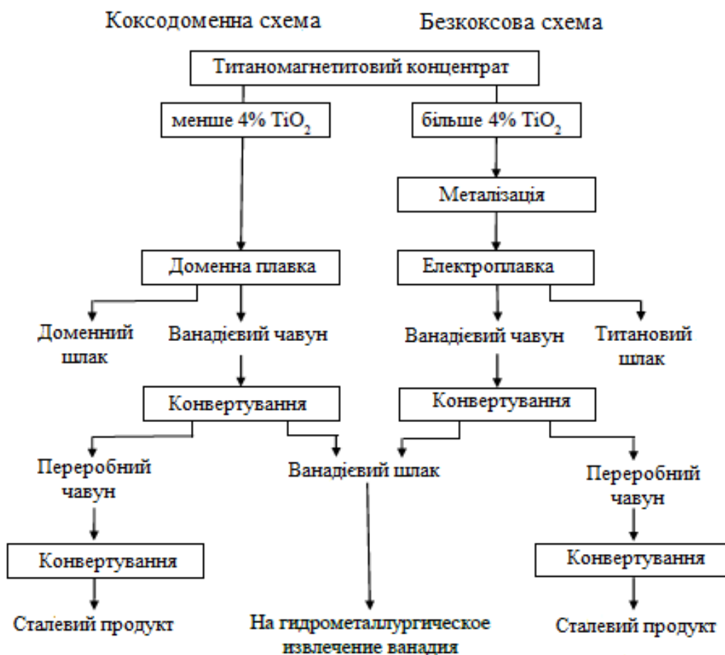
Рисунок 1.2 Технологічні схеми коксодоменної та безкоксової переробки титаномагнетитових концентратів
