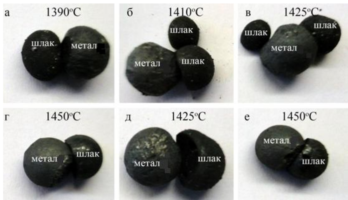
Рисунок 4.1 Загальний вид продуктів металізації титаномagnetитового концентрату твердим відновником з отриманням чавуну в області температур 1390-1450 °С. Дослід: а- №5, б - №4, в - №3, г - №1, д - №23, е - №10.
