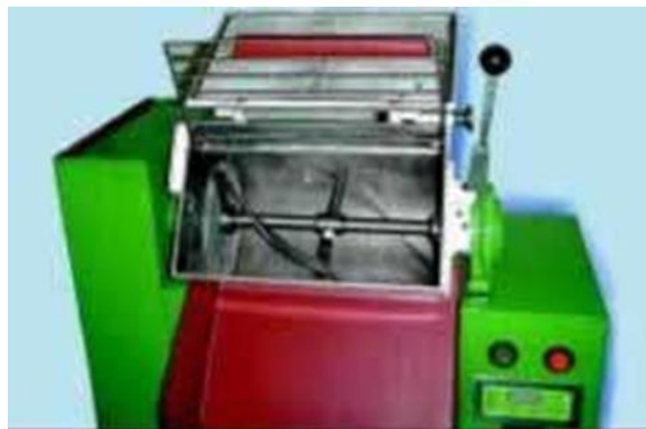
Рис. 3.4 Змішувальний пристрій – мішалка
