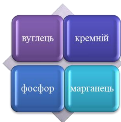
Рисунок 1.2 – Окислення домішок при виплавці сталі в сталеплавильних печах
