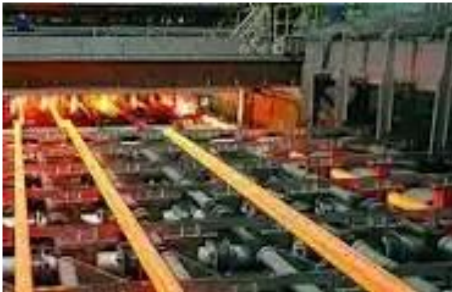
Рисунок 1.3 – Схема гарячого прокатування швелера
