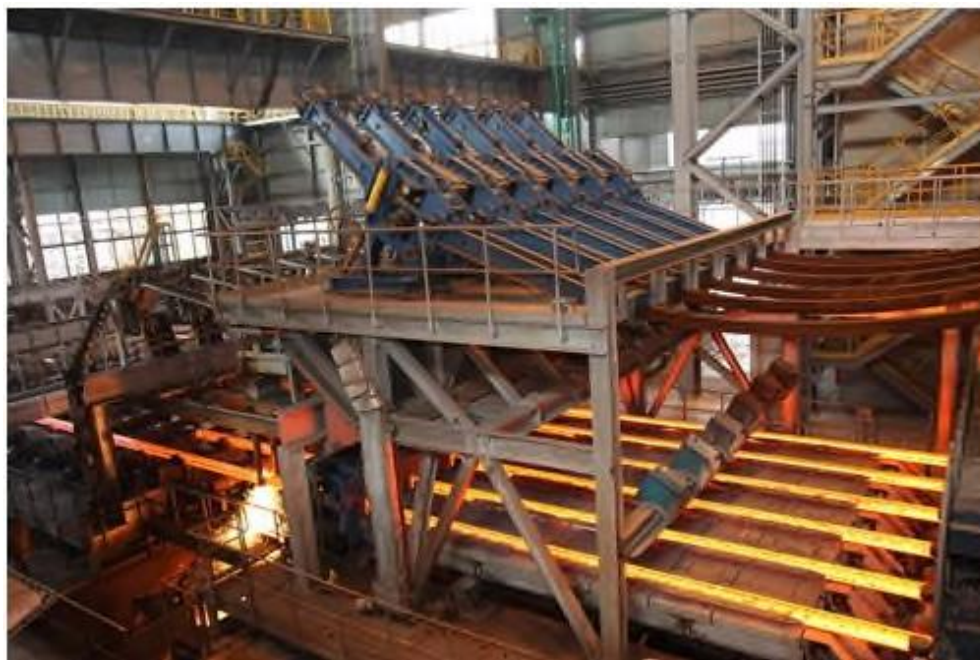
Рисунок 1.6 – Розливка сталі на МБЛЗ конвертерного цеху в умовах ПАТ «АрселорМіттал Кривий Ріг»
