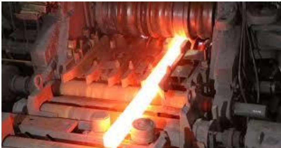
Рисунок 1.2 – Рух металу при поздовжньому прокатуванні
