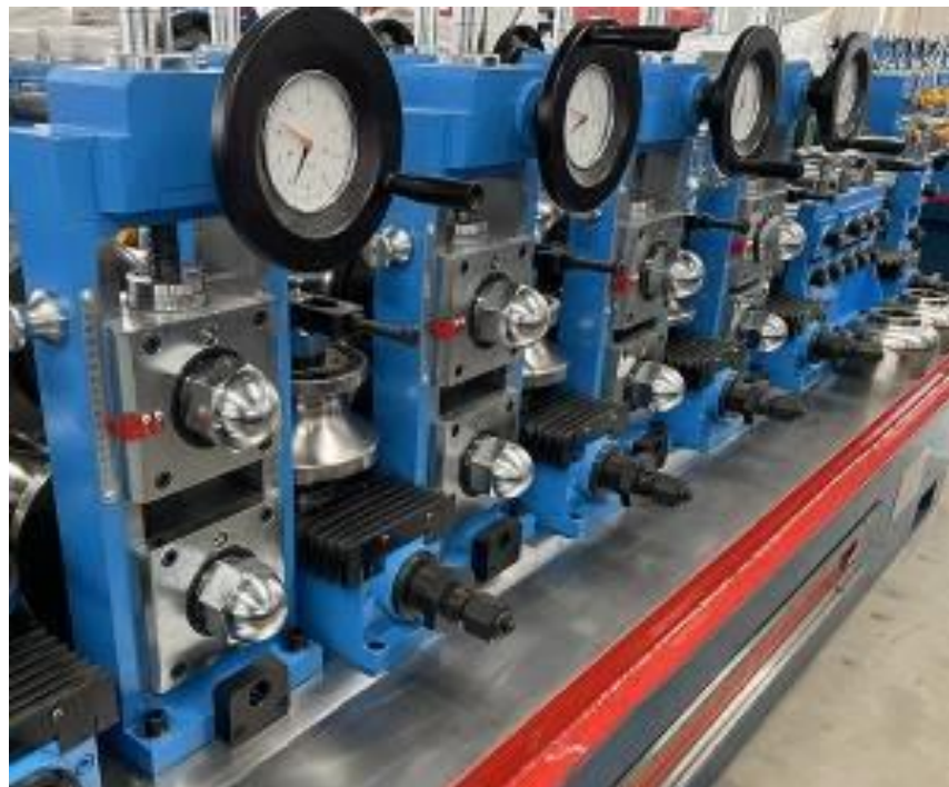
Рисунок 2.4 – Загальний вигляд безперервного трубопрокатного агрегату
