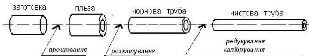
Рисунок 1.2 – Технологічна послідовність виготовлення безшовних труб
