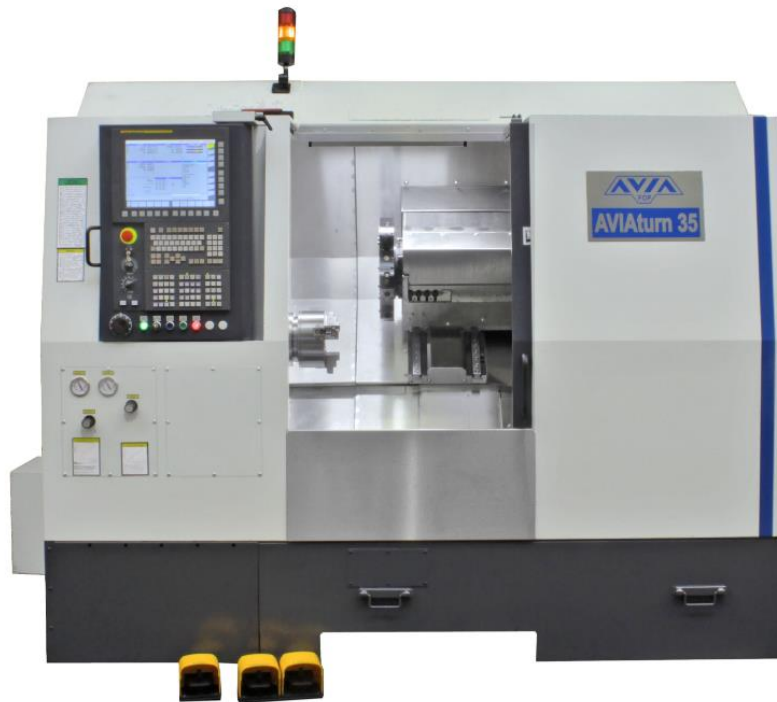
Рисунок 2.1 – Токарний верстат з ЧПК моделі AVIA серії AVIAturn 35.
