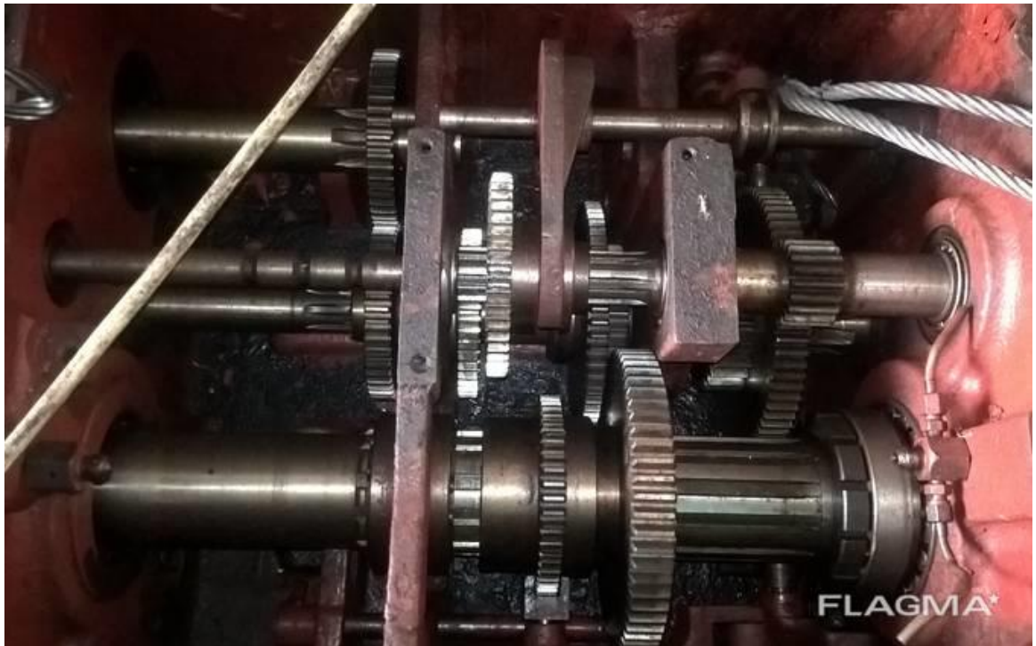
Рисунок 1.3 – Коробка швидкостей верстату 16K20Ф3С32
