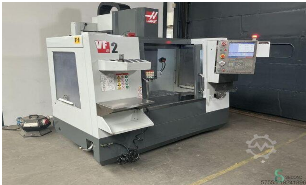
Рисунок 2.2 – Фрезерний верстат Haas VF-2SS
