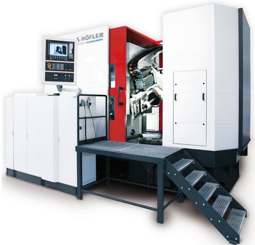
Рисунок 2.2 – зубофрезерний верстат Höfler HF 1250
