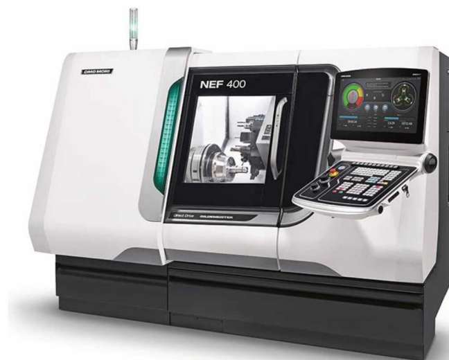
Рисунок 2.1 – Токарний верстат з ЧПК Gildemeister NEF400
