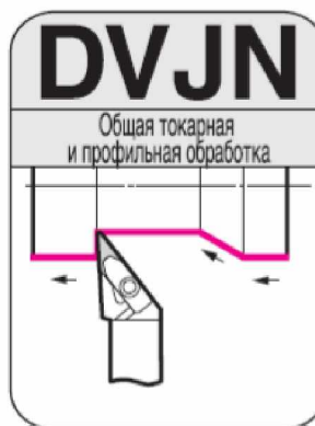
Рисунок 3.7 – Приклад використання обраного різця для зовнішньої обробки з ромбічною пластиною
