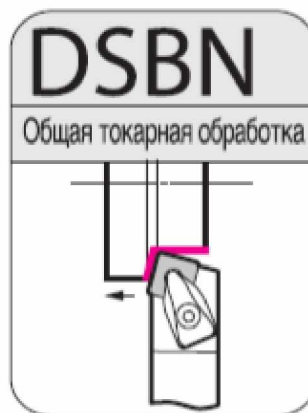
Рисунок 3.4 – Приклад використання обраного різця для зовнішньої обробки з квадратною пластиною
