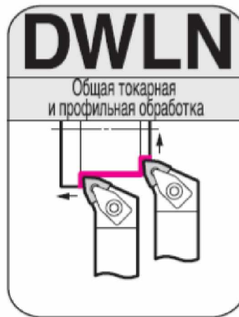
Рисунок 3.1 – Приклад використання обраного різця для зовнішньої обробки з ламаною тригранною пластиною
