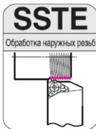
Рисунок 3.10 – Приклад використання обраного різця для зовнішньої обробки з тригранною пластиною
