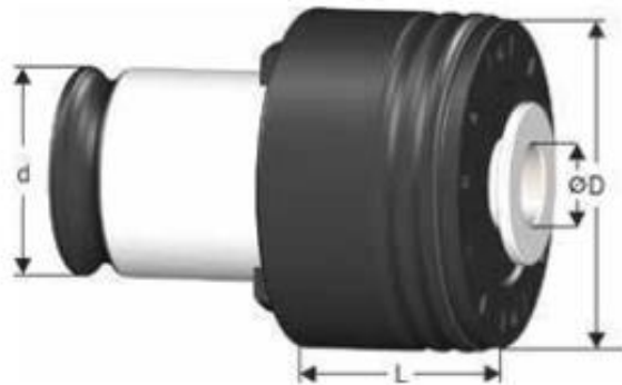
Рисунок 3.16 – Цанга для нарізання різьби M8 [8, G-25] Геометричні параметри: d=8 ; D=52 ; d=38 ; L=23
