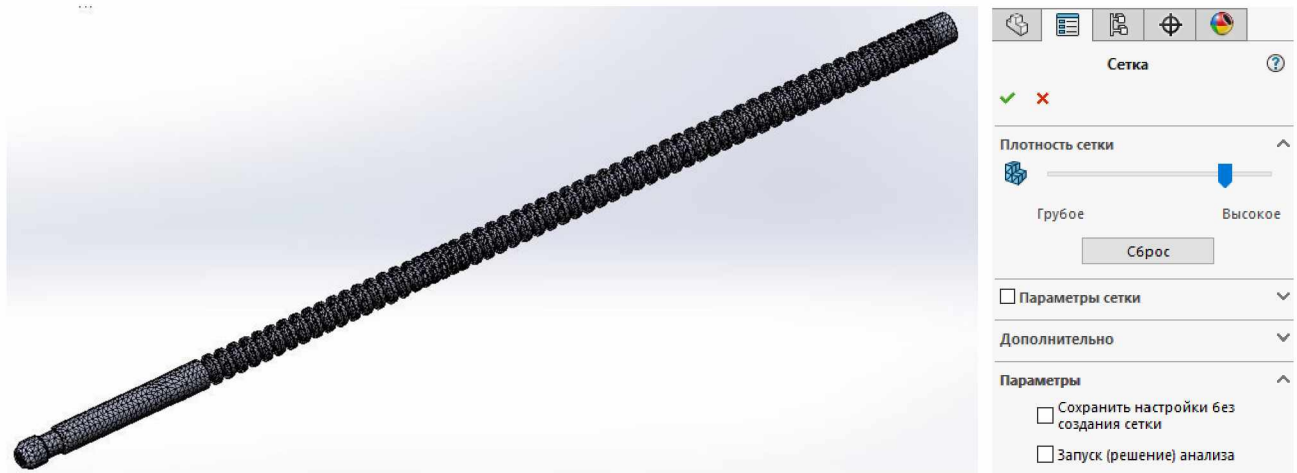
Рисунок 4.4 – Сітка на 3D-моделі інструменту та її параметри
