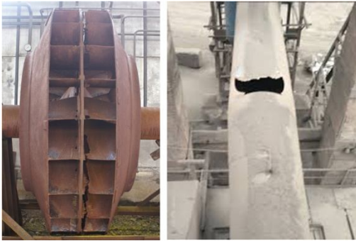
Рис. 1. Дія газообразивного зношування
