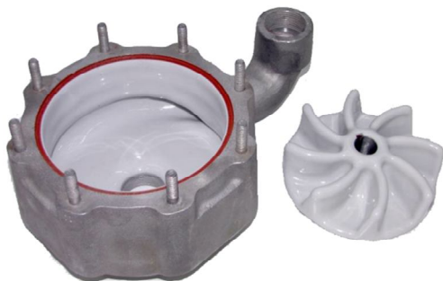
Рис. 5. Відновлений корпус і робоче колесо
