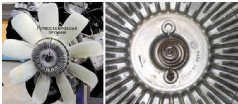
Рис. 1.8. Загальний вигляд вентилятора оснащеного віскомуфтою
