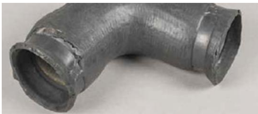
Рис. 1.18. Типовий вплив мастильних матеріалів на зовнішню поверхню еластичного патрубка системи охолодження двигуна.
