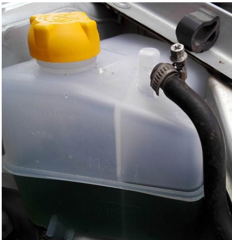
Рис.1.6. Загальний вигляд пробки встановленої на розширювальному бачку.
