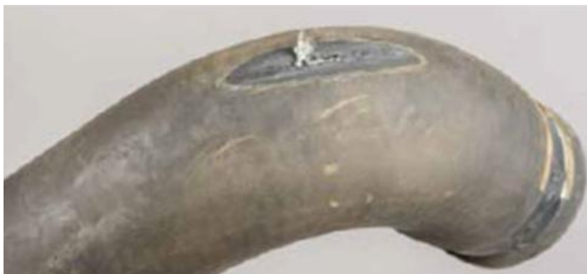
Рис. 1.17. Приклад механічного пошкодження еластичного патрубка системи охолодження автомобіля.
