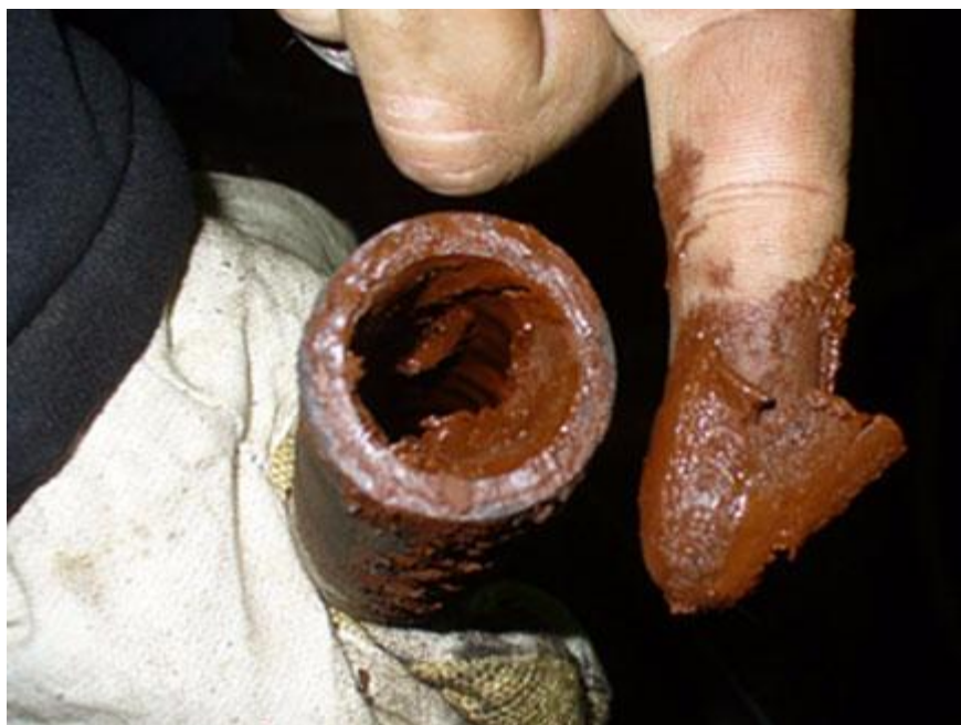
Рис. 1.20. Закупорювання підводячого патрубку головки блоку двигуна внутрішнього згоряння, внаслідок використання неякісної охолоджуючої рідини.
