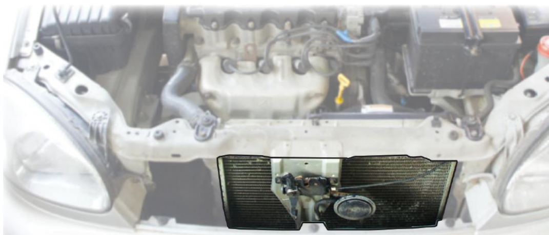
Рис. 1.3. Типове розташування радіатора охолодження в автомобілі.
