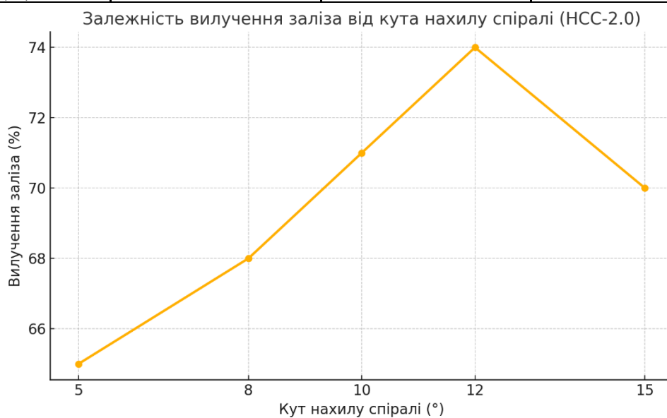
Рисунок 3.6 - Залежність вилучення заліза від кута нахилу спіралі (НСС-2.0)
