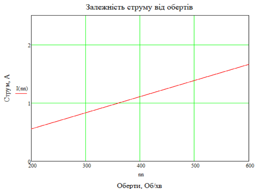
Рис. 2.10 Графік залежності струму на навантаженні від обертів валу СГ Через зазначені вище обмеження розрахунки будуть проводитись лише для 200, 300, 400, та 500 \frac{\text{Об}}{\text{хв}} .
