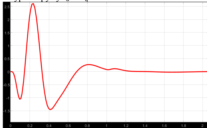
Рис.3.2. Динамічна характеристика контура струму I_d
