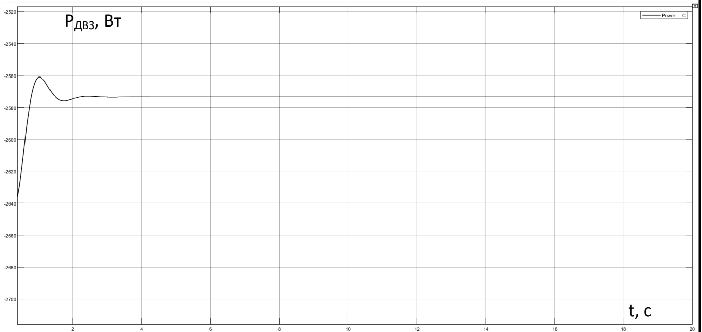
Рис. 2.44. Потужність гібридного тягового електромеханічного комплексу електромобіля
