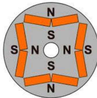
Рис. 1.9. Ротор двигуна з постійними магнітами
