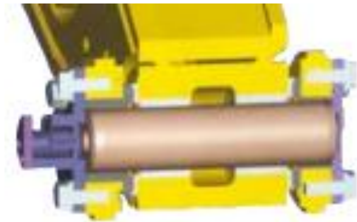
Рисунок 3.9 – Установка плаваючого пальця
