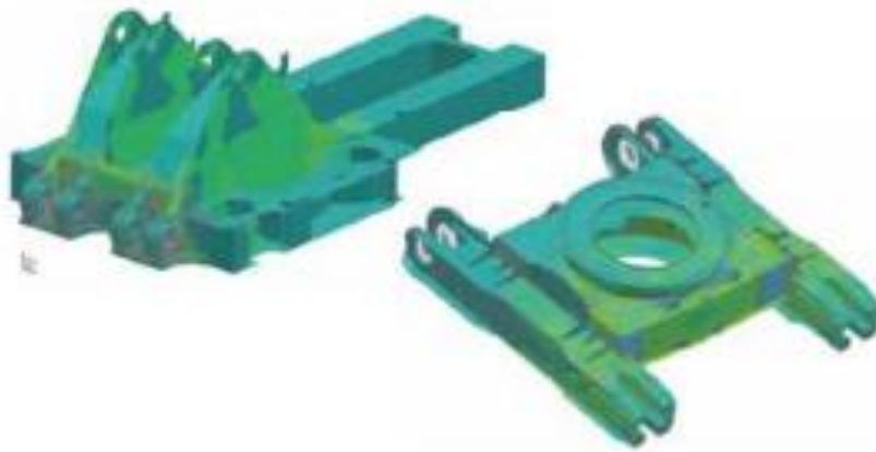
Рисунок 3.3 – Конструктивні елементи ходової частини екскаватора
