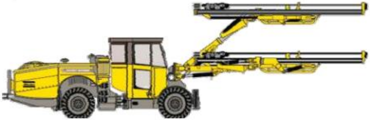
Рисунок 1.3 – Загальний вигляд шахтної бурильної установки Boomer M2C з двома бурильними машинами шведської фірми Atlas Copco
