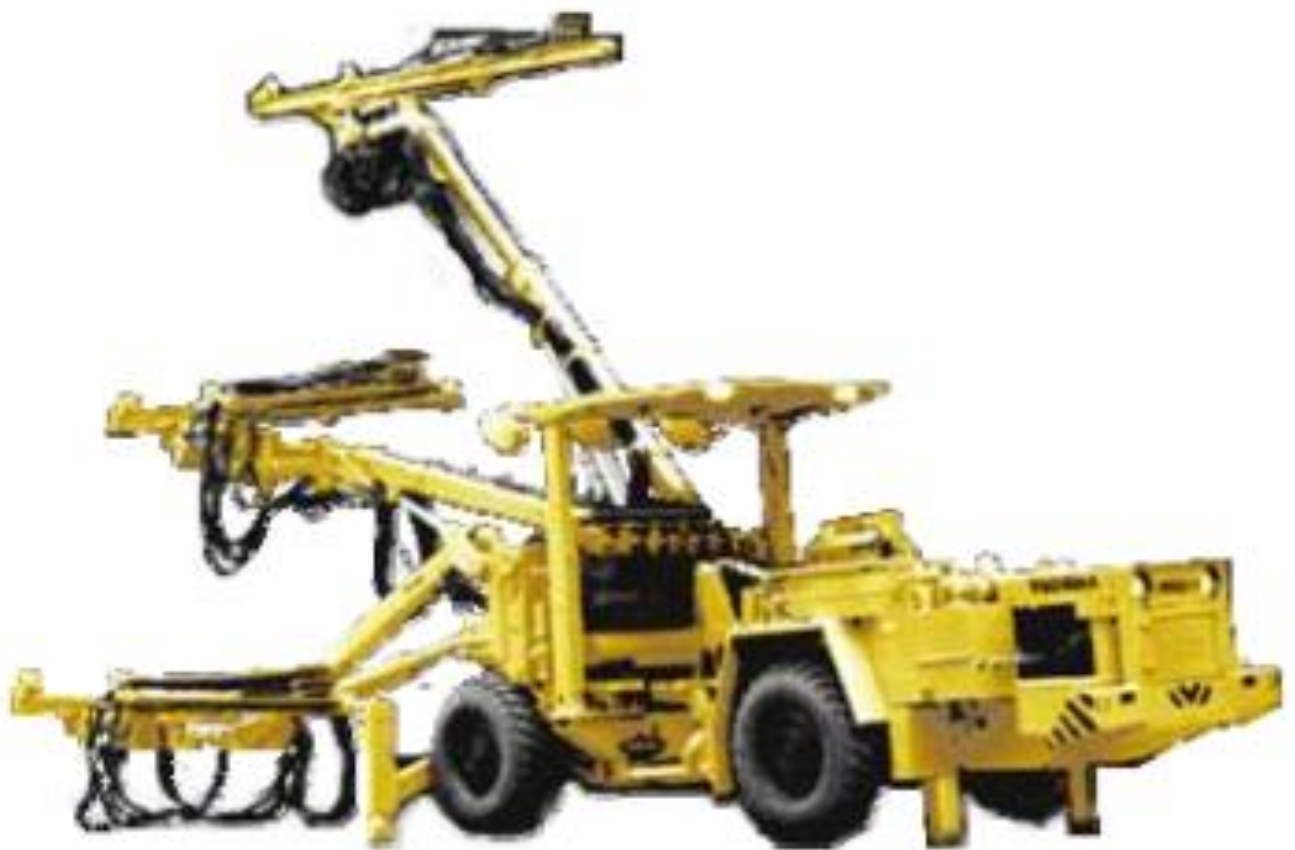
Рисунок 2.1 – Шахтна бурильна установка УБШ 501А у робочому положенні
