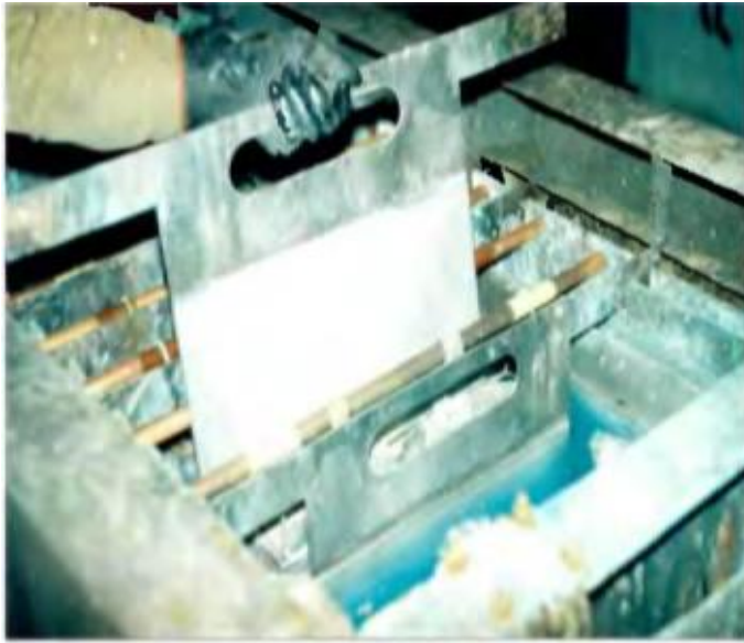
Рис. 3.2. Процес афінажу срібла електролізом а) - ванна електролізна; б) катод з афінованим сріблом
