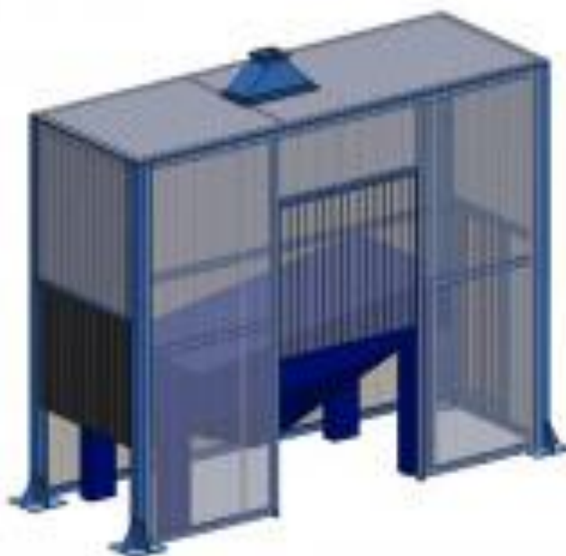
Рис. 3.13.3. Укриття для вібросита
