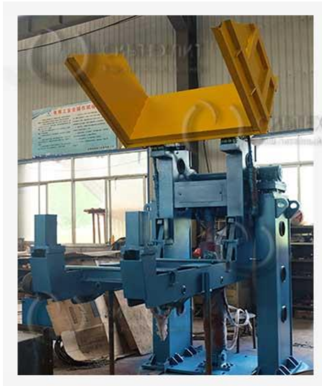
Рис. 3.3.2. Гідравлічний кантувач KWYF-01
