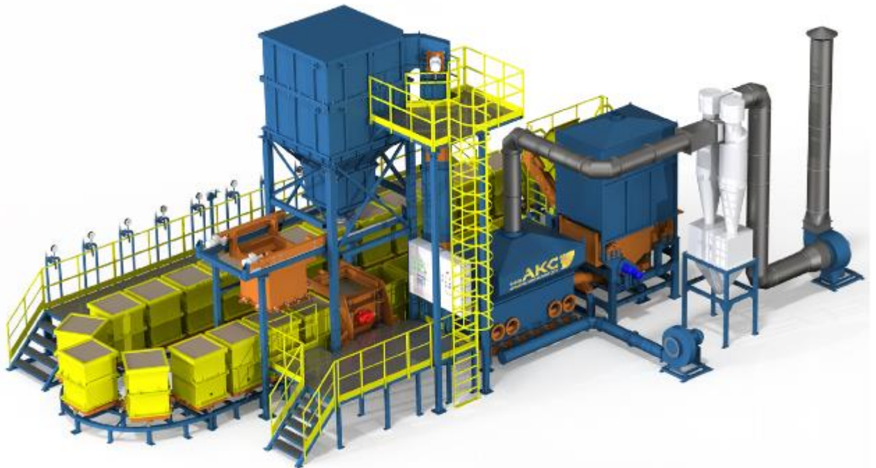
Рис. 3.23.4. Механізована лінія продуктивністю 12 форм/год із розміром мм.
