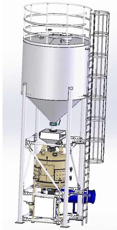
Рис. 3.20.1. Автоматизована установка регенерації формувального піску фірми «Neuhof»
