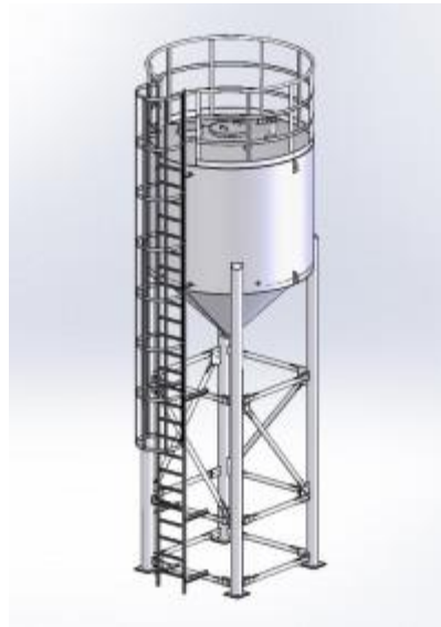
Рис. 3.10.4. Силос для гарячого піску
