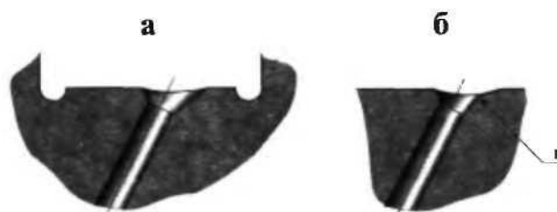
Рис. 2.32. Вигляд отвору подачі моторного масла на шатунну шийку: а - кутова фаска (найбільше часто застосовуваний варіант); б - радіусна фаска
