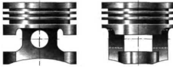
Рис. 2.63. Схематичне зображення сучасного Х-подібного поршня: економія маси та зменшення можливого теплового розширення завдяки відсутності середньої частини спідниці
