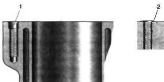
Рис. 2.11. Вигляд типової сорочки водяного охолодження блоку циліндрів ДВЗ.
