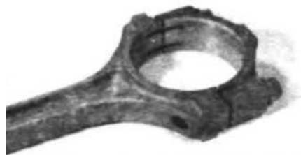
Рис. 2.53. Шатун сучасного двигуна з «колотим» розніманням кришки
