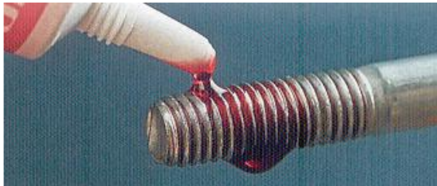
Рис. 4.2. Аплікація піддослідного анаеробного препарату на різьбову поверхню болта.
