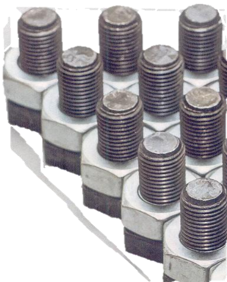
Рис. 4.1. Візуалізація групи піддослідних елементів кріплення з параметрами різьблення M10X1,25
