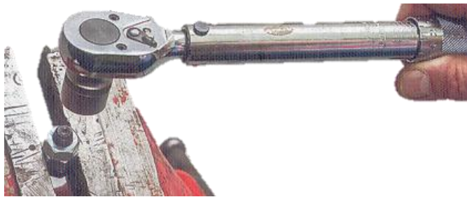
Рис. 5.1. Початковий момент відкручування встановлений на інструменті – 5 Нм.
