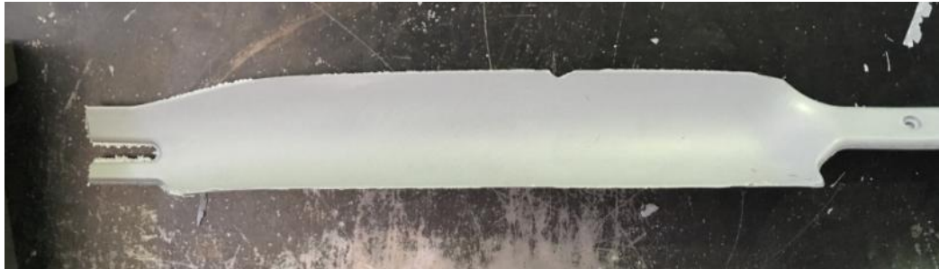
Рисунок 3.13 - Види браку стрижнів під час запресовування: a - утяжина; б - нерівності на вихідній кромці; в - злам кромки
