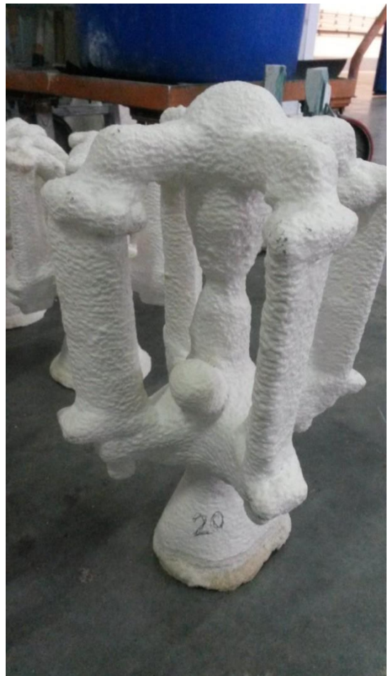
Рисунок 3.20 - Зображення блоку лопаток (а) і керамічної оболонки (б)
