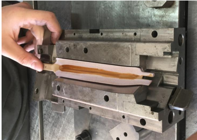
Рисунок 3.18 - Встановлення стрижня в прес-форму
