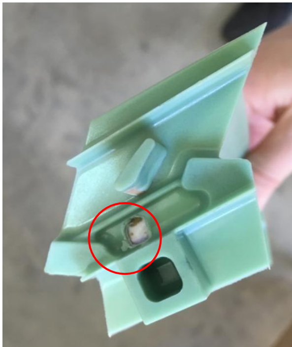
Рисунок 3.19 - Зображення моделі лопатки зі зламом хвостовика стрижня
