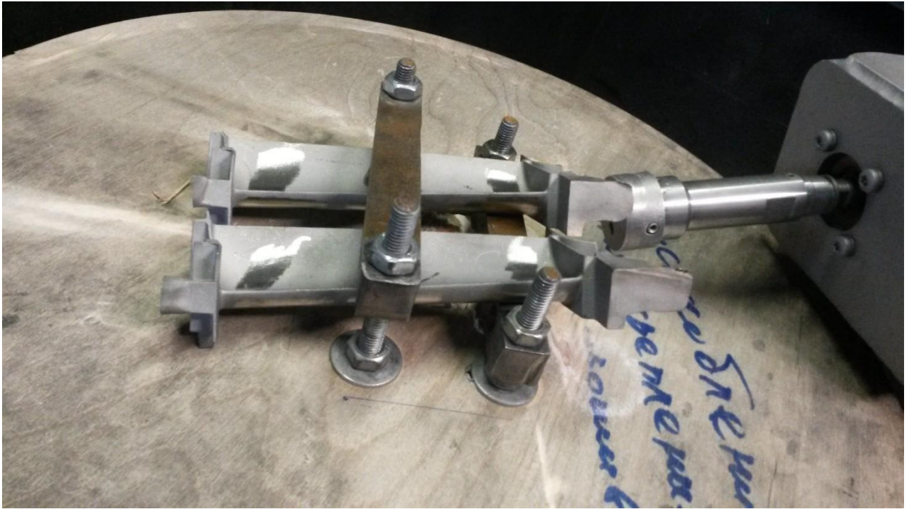
Рисунок 3.21 - Гідродинамічна установка для видалення стрижнів
