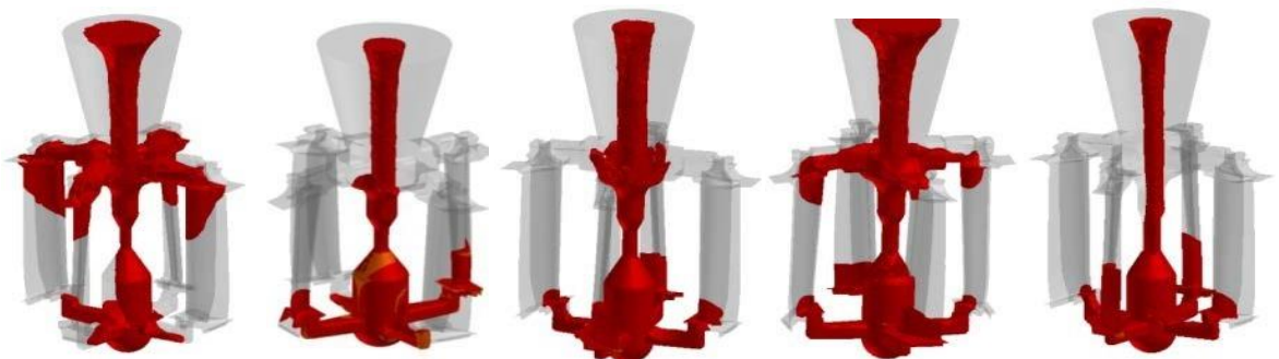
Рисунок 3.10 - Моделювання заливки блоків лопаток із діаметрами дроселя 11, 12, 14, 15,5 і 18 мм відповідно.
