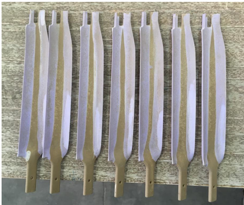
Рисунок 3.16 - Зовнішній вигляд просочених стрижнів
