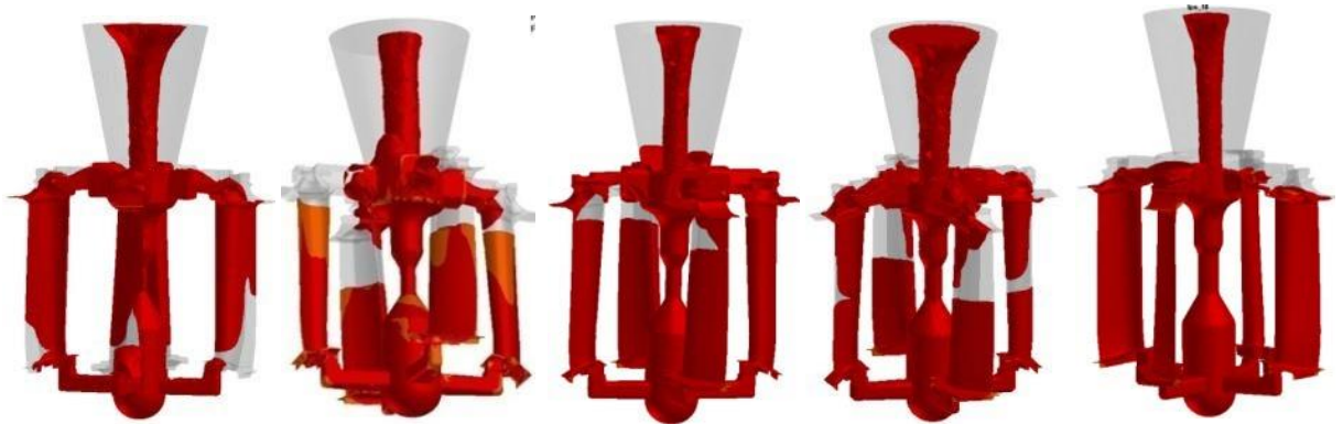
Рисунок 3.11 - Злиття потоків у блоках із діаметрами дроселя 11, 12, 14, 15,5 і 18 мм відповідно
