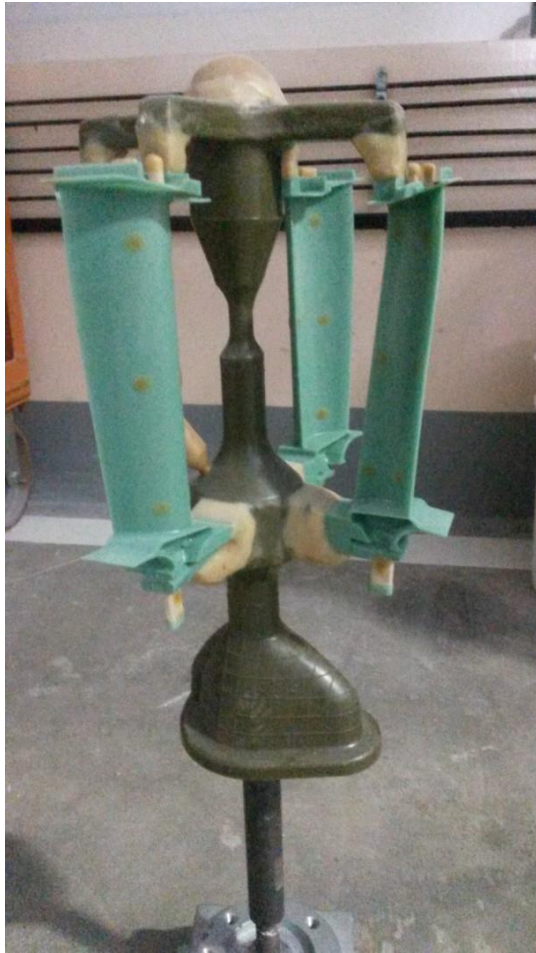
Рисунок 3.20 - Зображення блоку лопаток (а) і керамічної оболонки (б)
