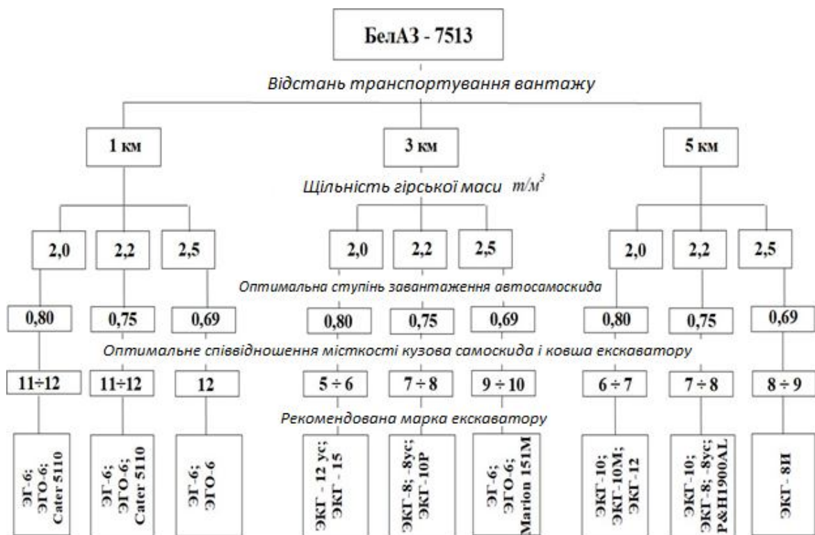
Рис. 1.1 – Алгоритм вибору умов експлуатації самоскиду (за Стеніним Д.В.)
