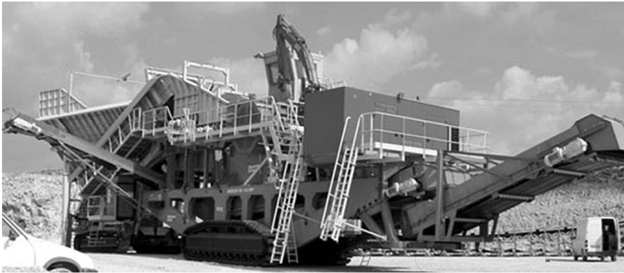
Рис. 1.9 – Зовнішній вид пересувної дробарної установки MC 160 PRR фірми «Kleemann»
