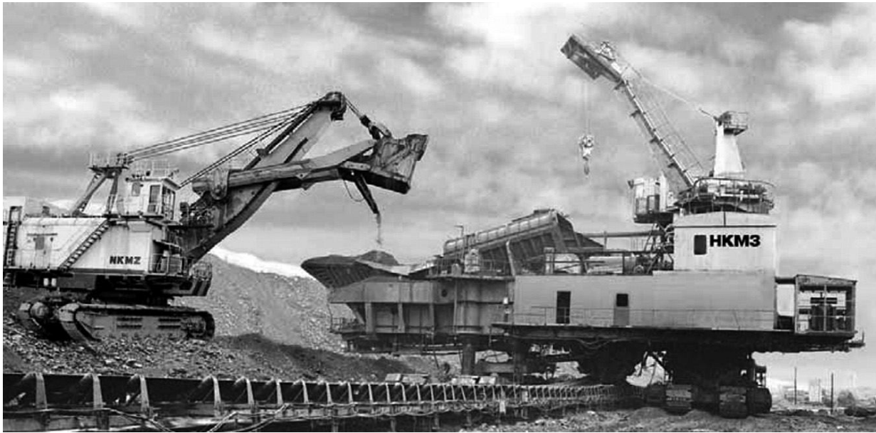
Рис. 1.5 – Самоходний агрегат ДПА-2000 на дослідно-виробничій ділянці ПРАТ «Центральний ГЗК»
