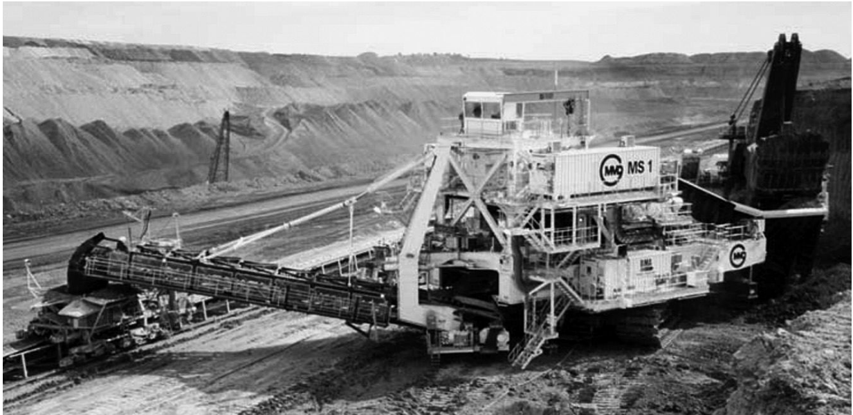
Рис. 1.7 – Навантаження гірничої маси екскаватором Р&Н-2800 в пересувну дробарну установку «Joy Global» (родовище «Goonyella», Австралія)
