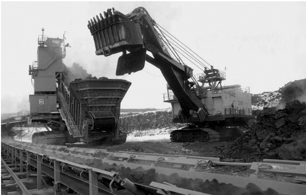
Рис. 1.4 – Мобільна дробарна установка «ThyssenKrupp Fundertechnik» на кар'єрі «Yimin He», КНР
