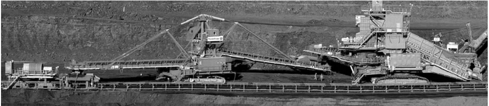
Рис. 1.10 – Комплекс циклічно-поточної технології, що включає механічну лопату, мобільний дробарно-перевантажувальний бункер і конвеєрний перевантажувач (виробництво компанії «ThyssenKrupp Fundertechnik» на кар'єрі «Yimin He», КНР)
