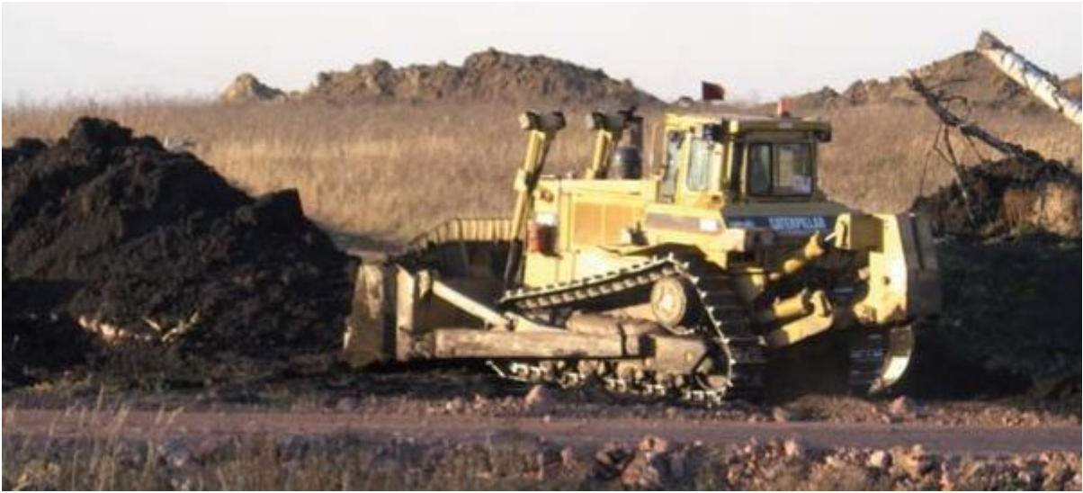
Рисунок 5 - Бульдозер Caterpillar D8 на знятті родючого ґрунту на кар'єрі «Бородинський»
