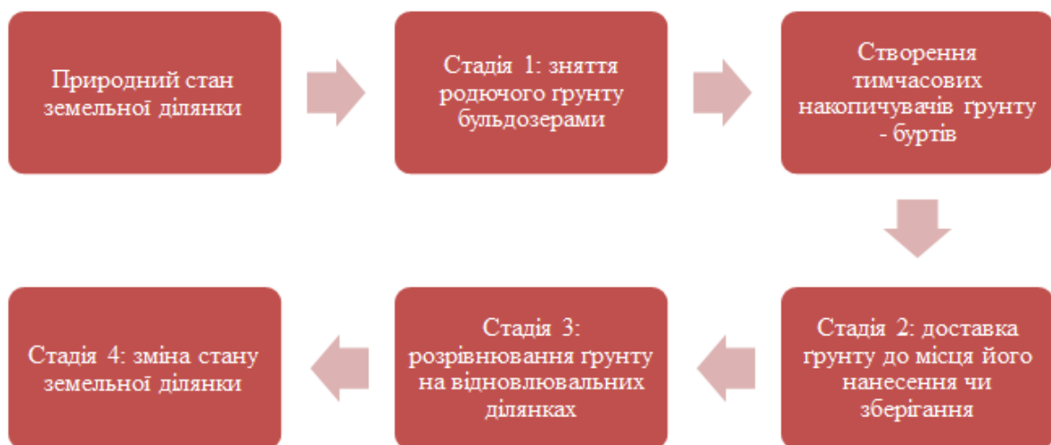
Рисунок 4 - Класична послідовність проведення гірничотехнічної рекультивації
