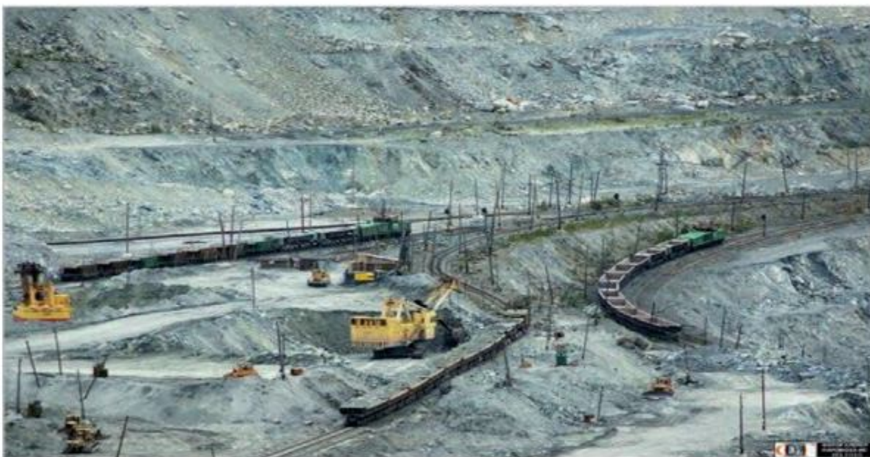
Рис.16 – Перевантажувальний пункт із двостороннім під'їздом залізничного транспорту
