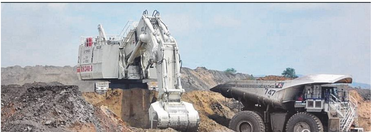
Рис. 20 – Звичайна схема навантаження самоскида екскаватором із зворотною лопатою
