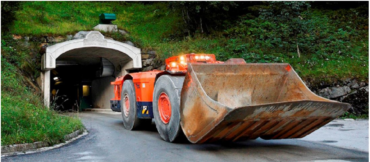
Рис. 2.3. Головний вхід у підземну вольфрамову шахту Mittersill (Австрія) з вантажно-доставочною машиною, що виїздить з нього, (Фото: Wolfram Bergbau und Hutten AG).
