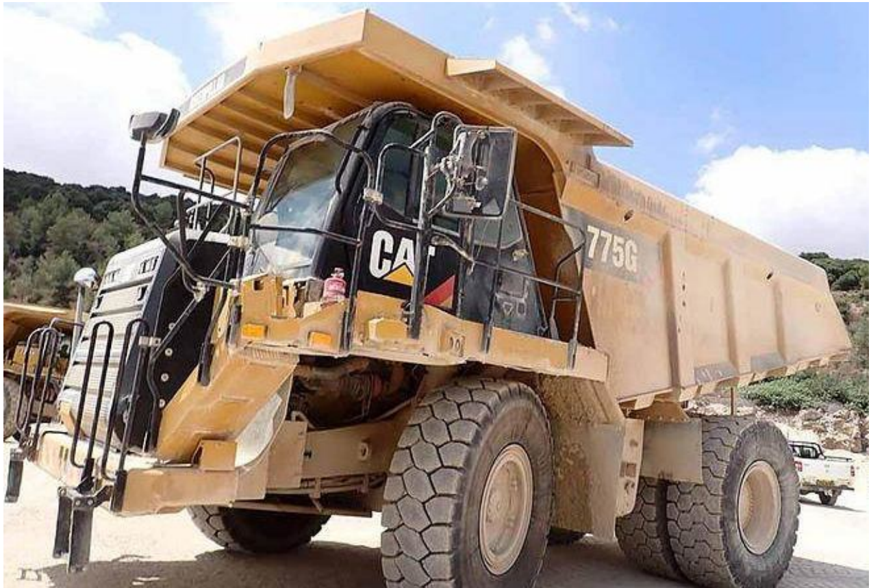
Рис. 1.7. Кар'єрний автосамоскид CAT 775G (Джерело: https://www.pon-cat.com/no/pon-equipment/produkter/cat-produkter/dumpere/tipp-trucker/cat-775g [30])
