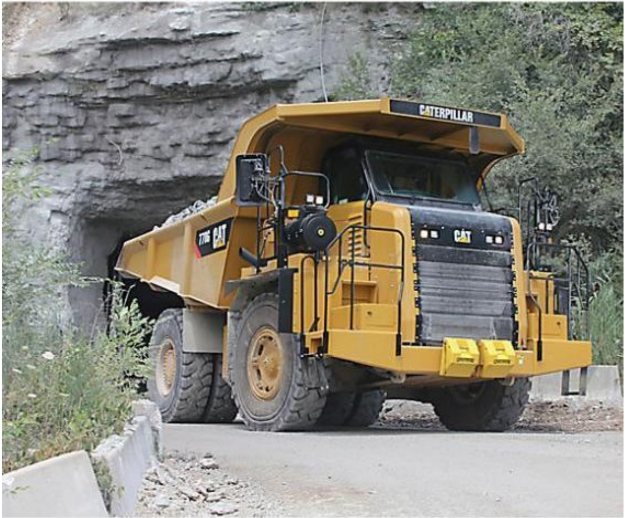
Рис. 1.8. Кар'єрний автосамоскид CAT 770G на виїзді зі штольні шахти в кар'єр (Джерело: https://www.lectura-specs.com.ua/ua/model/budivel-na-tehnika/samoskidi-iz-zorstkou-ramou-caterpillar/770g-315 [31])
