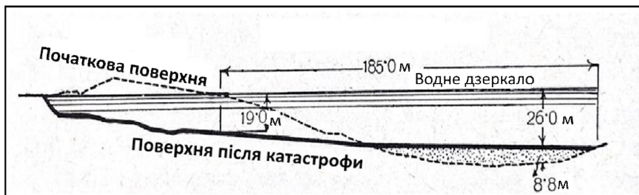
Рис. 2.1. Вигляд у розрізі потоку просідання або «піскопаду» на узбережжі Нідерландів [71]
