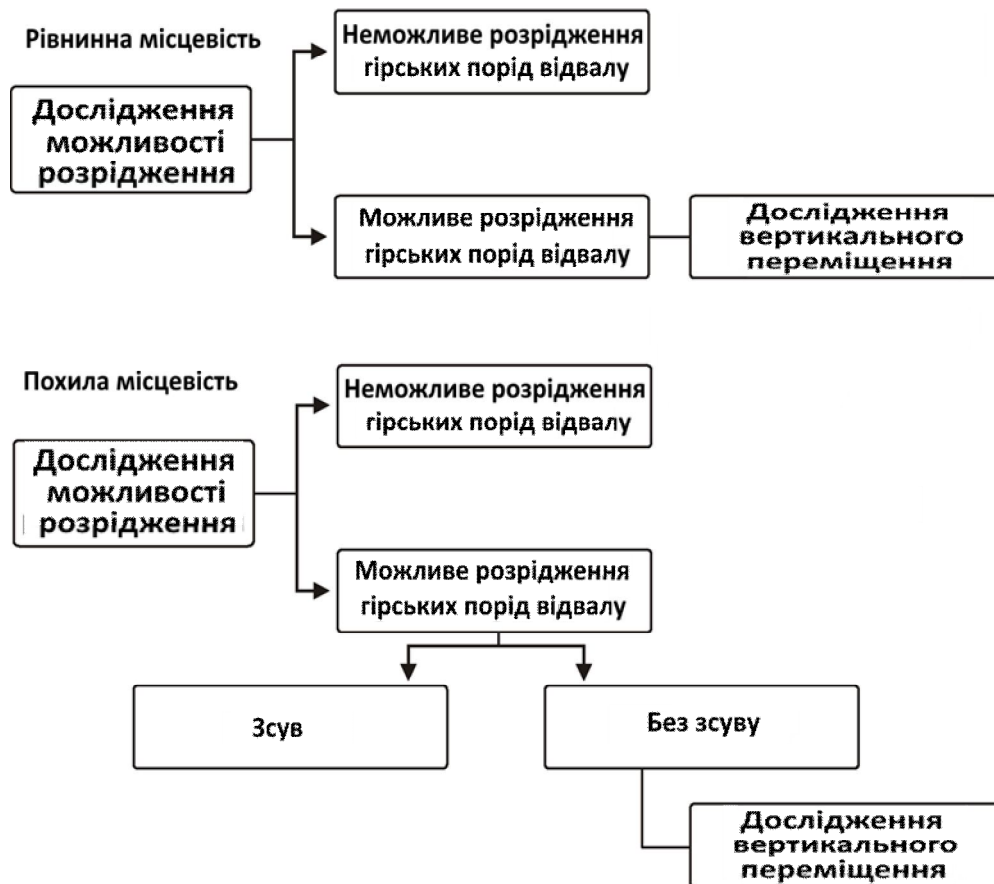
Рис 2.2. Схема проблем, пов'язаних з розрідженням порід відвалів, які необхідно враховувати (згідно з [56])
