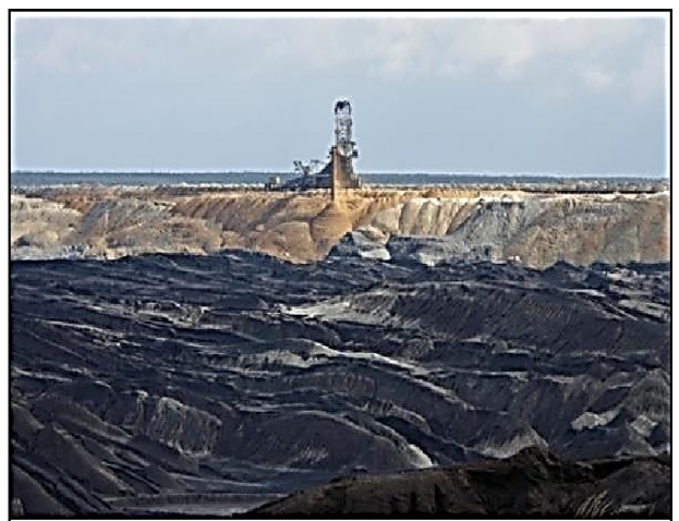
Рис. 2.14. Багатоковшевий екскаватор у попередньому розрізі (відкритий кар'єр Єншвальде) та розкидач у глибокі відвали через відвал АФВ (відкритий рудник Нохтен)
