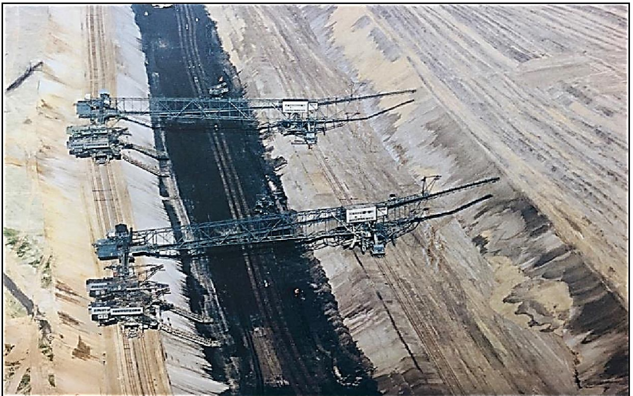
Рис 2.11. Два AFB F34 у колишньому кар'єрі Seese-Ost під час роботи з двома мостами [95]
