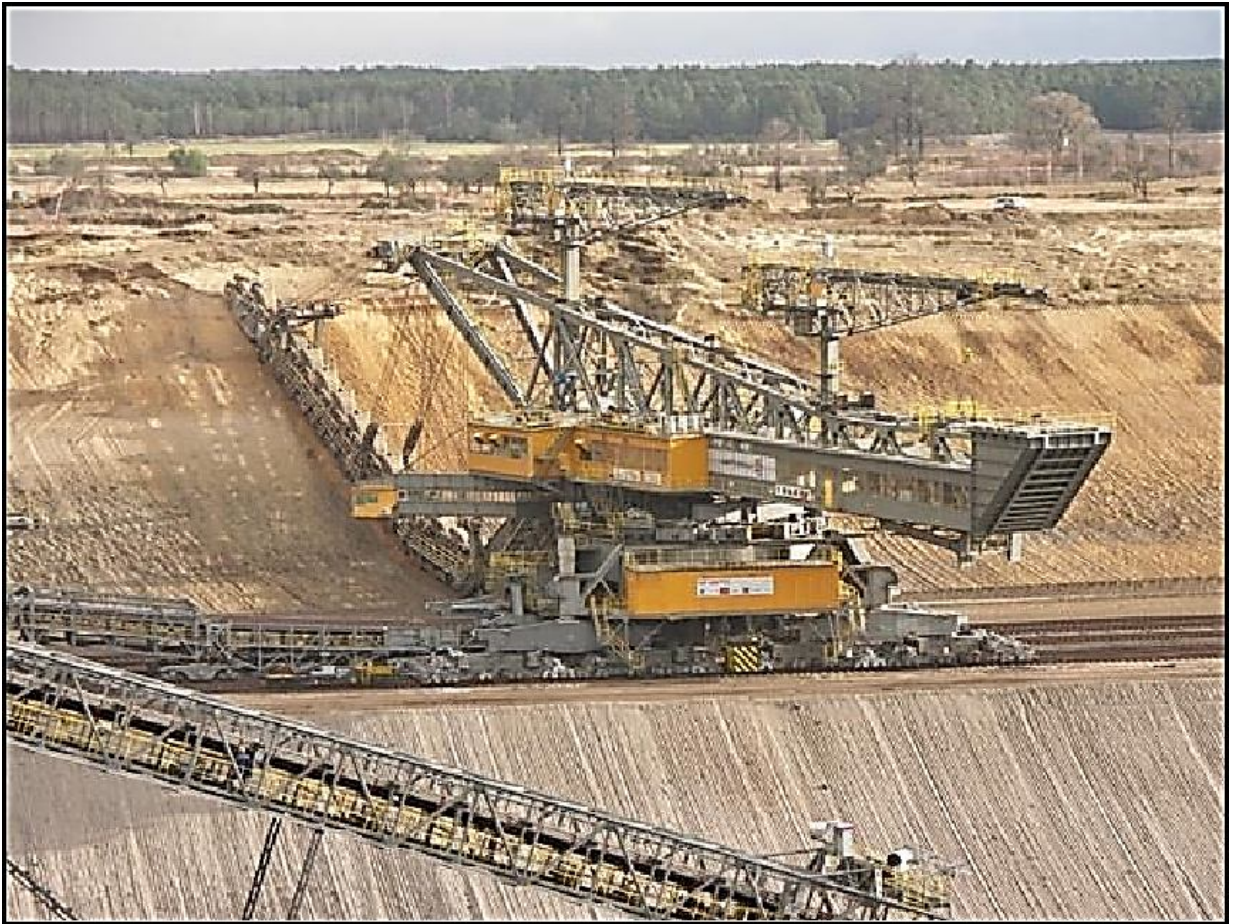
Рис. 2.10. Одноковшовий ланцюговий екскаватор у кар'єрі Reichwalde (високий різ, без попереднього різання) [95]
