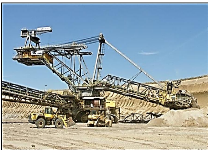
Рис. 2.14. Багатоковшевий екскаватор у попередньому розрізі (відкритий кар'єр Єншвальде) та розкидач у глибокі відвали через відвал АФВ (відкритий рудник Нохтен)
