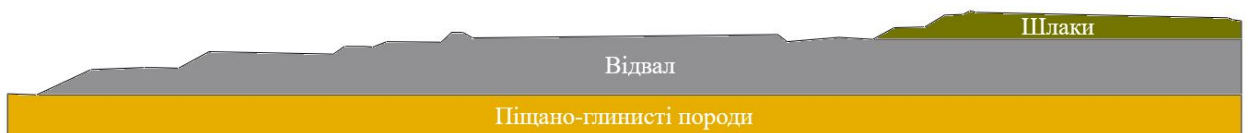
Рис.2.5. Розріз 1 з нанесеною геологічно будовою масиву
