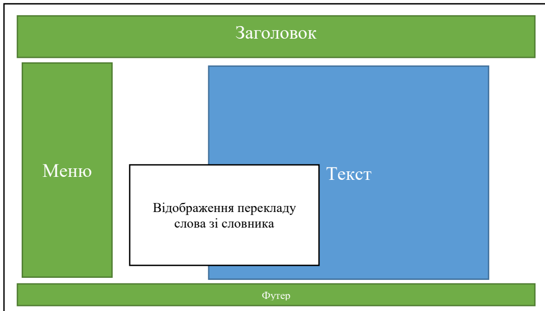
Рисунок 2.6 – Схематичне зображення інтерфейсу відображення перекладу слова зі словника під час читання художнього тексту
